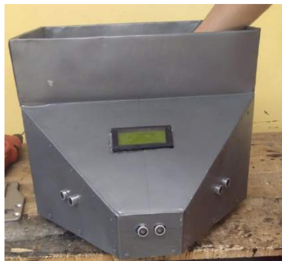
Figura 12 – Processo de Instalação de Sensores e LCD Fonte: Autoria Própria.
