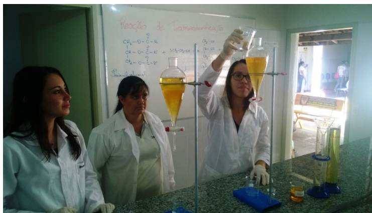
Figura 5 – Alunas do projeto realizando o procedimento de Lavagem do Biodiesel para purificação e extração de glicerina sob a supervisão da Professora Marisa Isabel Remedi (ao centro).
