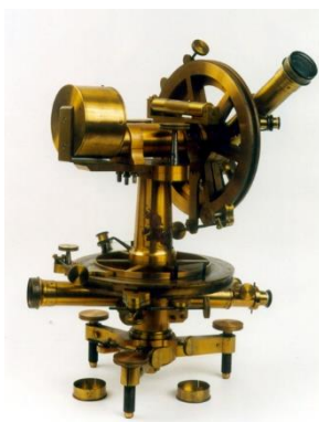
Figura 5: Teodolito astronômico - Acervo MAST
