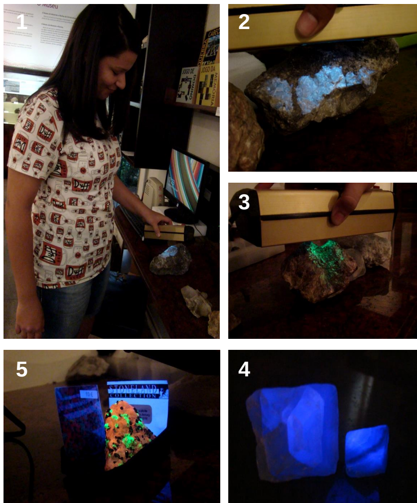
Figura 5- Monitara demonstrando o uso do mineralight de onda longa na identificação da scheelita; 2. Fluorescência branca da scheelita em scarn (rocha metamórfica); 3. Fluorescência azul-violeta da fluorita; 4. Fluorescência verde neon da autunite; 5. Fluorescência laranja da calcita e verde da willemite. Fotos: Acervo do MMR.
