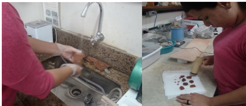
IMAGEM 6 - Lavagem do recipiente de acondicionamento e secagem da amostra com uso do secador de cabelos convencional para aceleração do processo, usando como apoio papel alcalino e papel toalha a fim de absolver a umidade em excesso deliberada pelo material.
