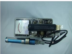
Figura 12 – Fotografia superior do cintilômetro nº 108, modelo DG-7.
