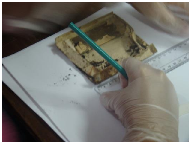
IMAGEM 3 - Retirada cuidadosa da etiqueta original, transcrição de dados nela contida para preservação das informações, aferição das medidas originais da caixa de acondicionamento, descarte desta e confecção de uma nova preservando as mesmas medidas originais da caixa primária.
