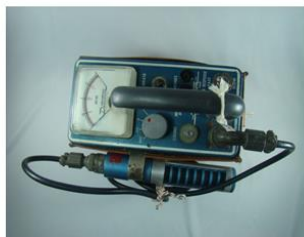
Figura 4 – Fotografia superior do cintilômetro nº 107, modelo DG-2.
