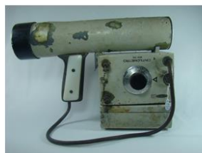
Figura 7 – Fotografia de perfil do cintilômetro nº 134, modelo 345.
