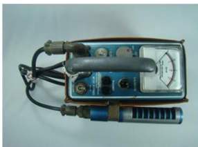
Figura 6 – Fotografia superior do cintilômetro nº 109, modelo DG-2.
