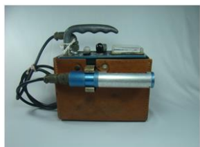
Figura 5 – Fotografia de perfil do cintilômetro nº 109, modelo DG-2.
