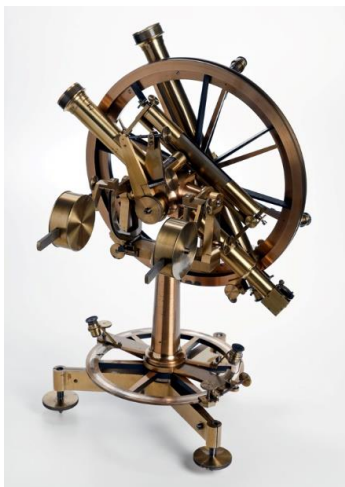
Figura 5: Círculo de borda ou teodolito - Acervo MAST
