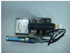
Figura 12 – Fotografia superior do cintilômetro nº 108, modelo DG-2.
