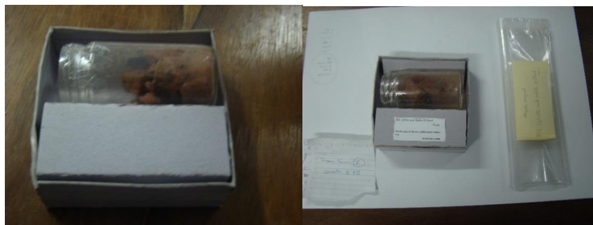
IMAGEM 9 - Resultado final após a confecção da caixa em papelão cinza gramatura desconhecida, de acomodação secundária da amostra, nas mesmas proporções de dimensão: largura, profundidade e altura. Com a replicação dos dados originais contidos na etiqueta. A etiqueta original foi mantida resguarda em papel alcalino para aumentar o tempo de vida dos dados nela impresso, como também, sua
