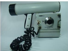
Figura 9 – Fotografia de perfil do cintilômetro nº 115, modelo 345.
