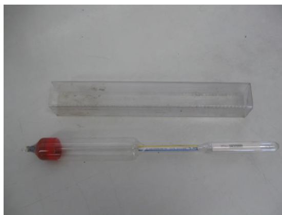
Fig. 7 – Lactodensímetro para determinação de densidade do leite. Fonte: Acervo do Centro de Memória da Escola Técnica Estadual Carlos de Campos
