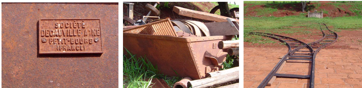
Figuras 59, 60 e 61. À esquerda: placa de Decauville Ainé em vagonete basculante existente na Fazenda Pinhal, em São Carlos - SP. À direita, trilhos do sistema Decauville de bitola de 0,40m implantados no Pinhal recentemente no terceiro plano de terreiro, próximo à tulha. (Imagens feitas por Cristina de Campos, em 2005).
