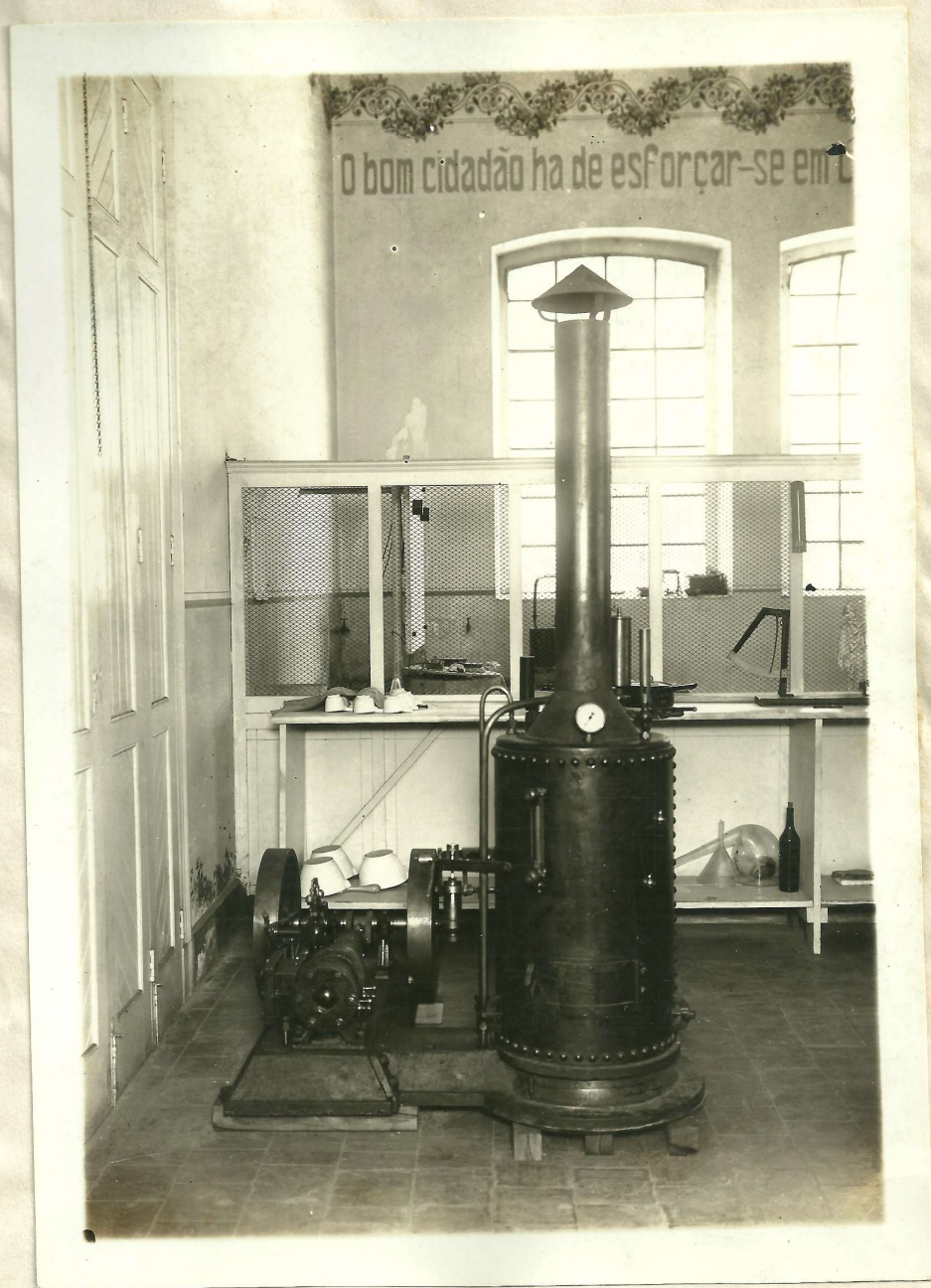
Machina á vapor de 2 H.P. desenhada, fundida, torneada e ajustada pelos alumnos do 3º anno do curso de mechanica. --TODA DE MATERIAL NACIONAL--
